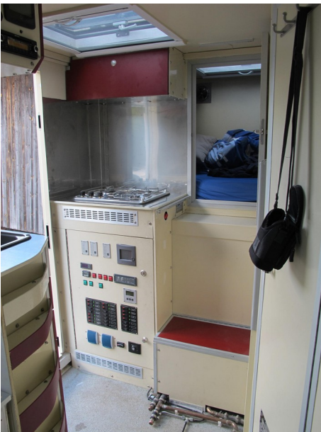
Kochecke, darunter Elektrozentrale; rechts Zugang zur Schlafkoje
