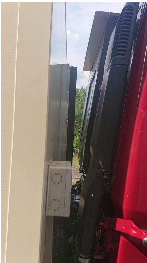
Das Fahrerhaus kann ganz einfach gekippt werden ohne irgendwelche Verriegelungen lösen zu müssen und ist trotzdem dicht
