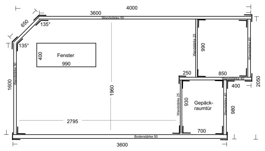
Konstruktion: Die Seitenwände stehen "neben" der Bodenplatte Rück- und Vorderwand auf der Bodenplatte und zwischen den Seitenwänden Dach auf den Seitenwänden und auf der Rückwand
